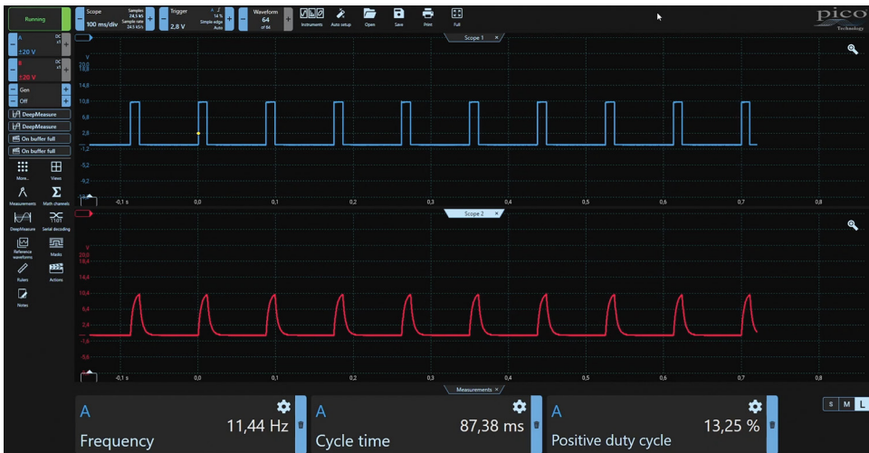
PWM jelek a KE1, 15. fejezetének második videójából.
